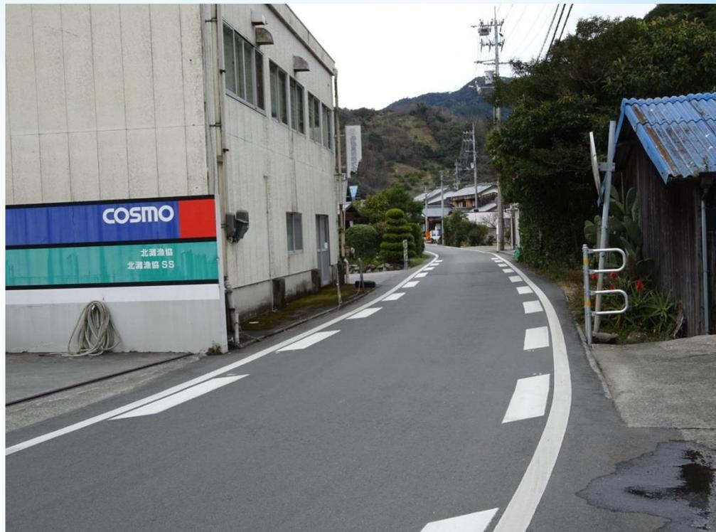
ドットライン（減速マーク）を設置し、視覚的にドライバーが減速できやすくなりました。また、側溝の開口部に転落防止柵を設置し、より安全に通行できるようにしました。
