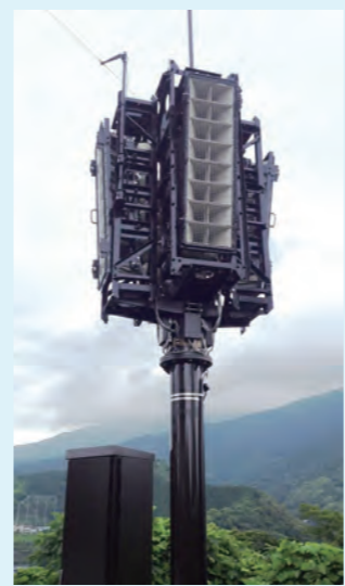
広範囲屋外拡声器(ホーンアレイスピーカー) 1基で約800m程度が可聴範囲です。
