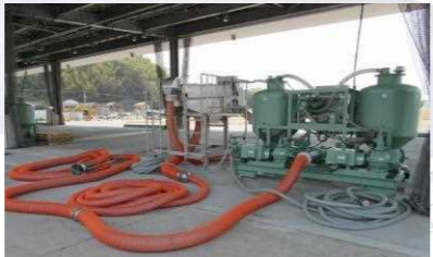
フィッシュポンプ(左)と魚体選別機(右) 水揚げの効率化により鮮度を保つことができる
