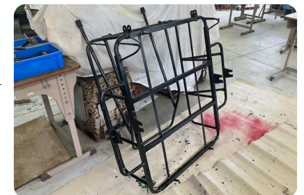
溶接を駆使して作成した折り畳み式リヤカー
