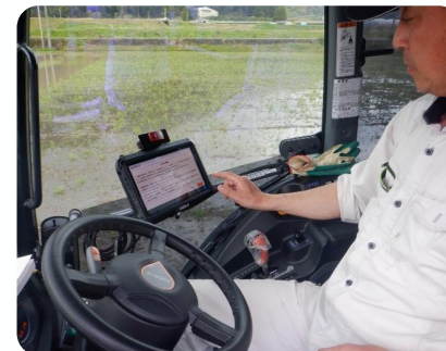
慣れた手つきで「自動操舵システム」を操作
