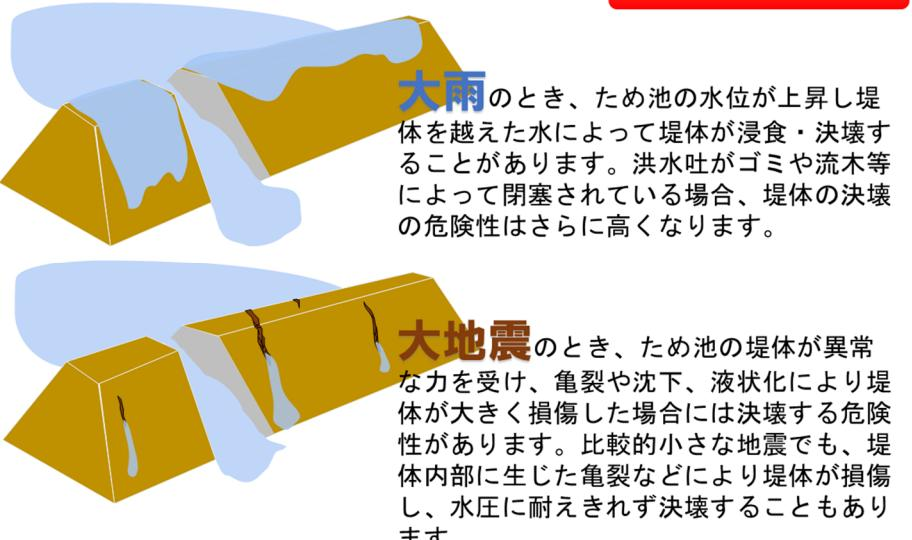
**大雨**のとき、ため池の水位が上昇し堤体を越えた水によって堤体が浸食・決壊することがあります。洪水吐がゴミや流木等によって閉塞されている場合、堤体の決壊の危険性はさらに高くなります。
