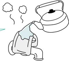
凍結した状態で蛇口を無理にひねると、水道管やゴムパッキンが破裂する場合がありますので注意してください。凍結で水が出ないときは蛇口を開けたままにせず、必ず蛇口を閉めてください。
