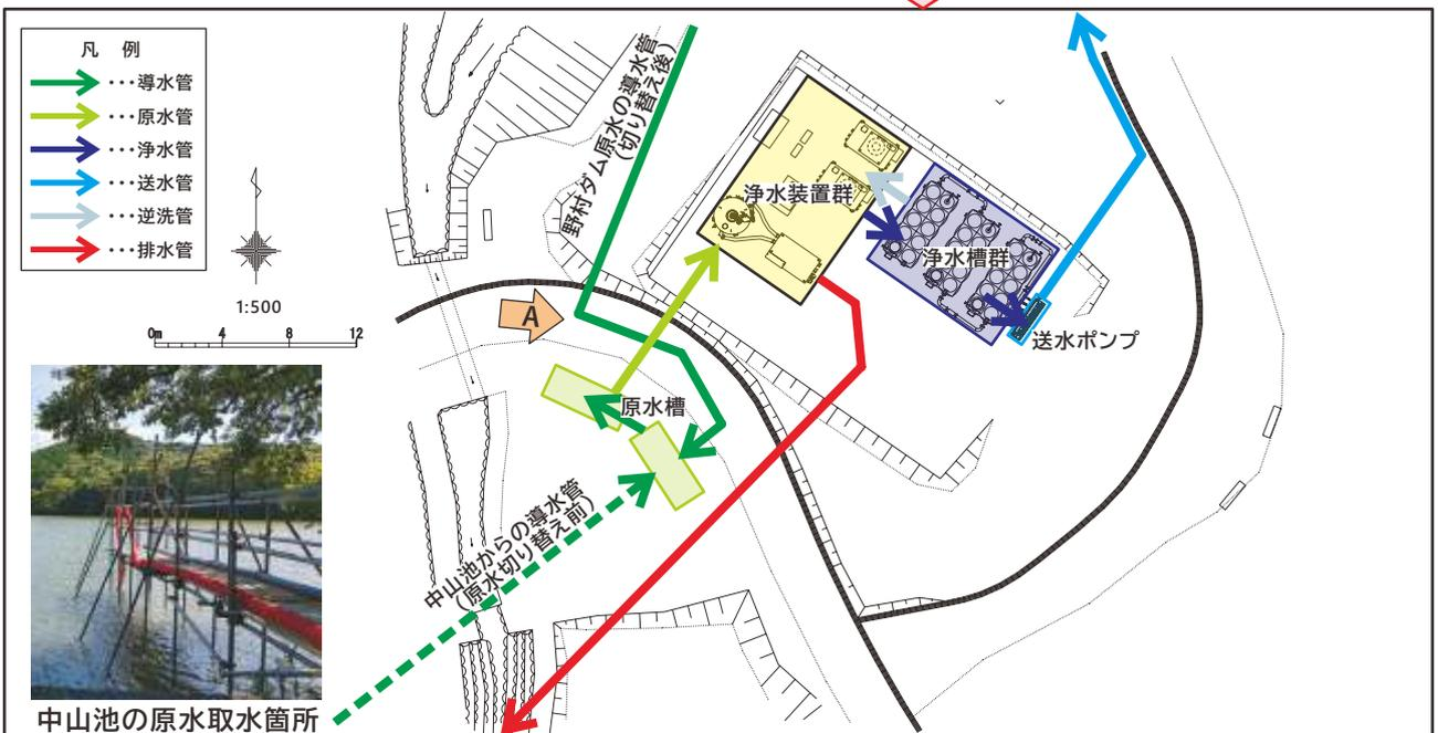
三間仮設浄水設備概略平面図
