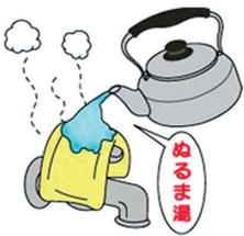
※熱湯をかけると、水道管が破裂する危険があるため、必ずぬるま湯で行ってください。
