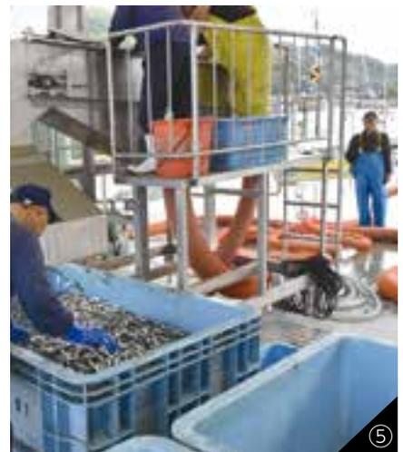
①施設全景。②夜も明けぬうちから漁船がつぎつぎと魚を運んできます。③どんどん運ばれてくる魚を、慣れた手つきで選別していきます。④計量を終わると、いよいよセリの準備が整います。⑤船から直接水揚げができるフィッシュポンプ。魚体の損傷を抑えることができます。⑥魚を大きさで選別することができる魚体選別機。水揚げを効率化して鮮度を保ちます。⑦5月12日(火)に開市となり、開市式と初セリが行われました。
