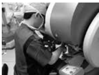
コンソール：術者が3Dモニターを覗きながらロボットアームを操作しているところ。
